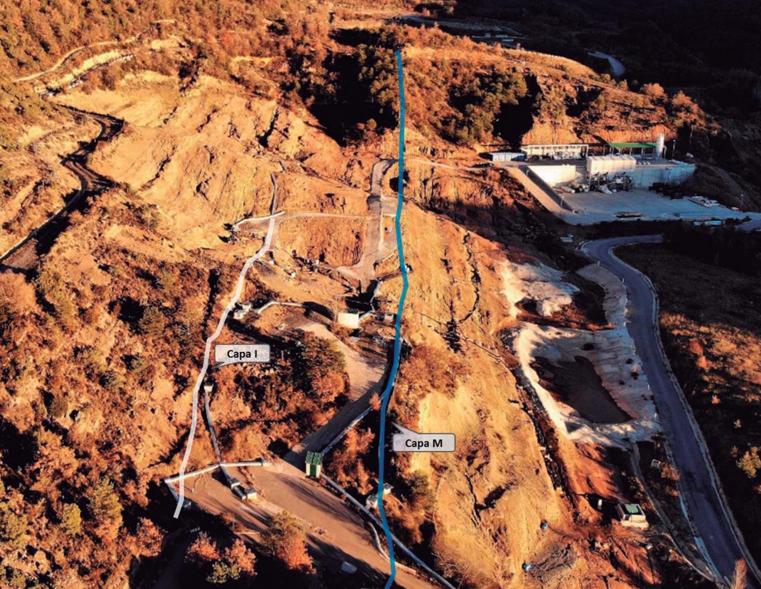
Foto del antiguo vertedero de Baillín ya desmantelado con su traslado a una nueva celda de seguridad, dejando al descubierto una ladera de roca de 3 hectáreas de superficie conforme a la imagen anterior. Las escorrentías generan sedimentos con nivel medio de contaminación por residuos de la fabricación de lindano. El objetivo de estos ensayos es transformar los sedimentos en tierra vegetal para restauraciones en el mismo emplazamiento
